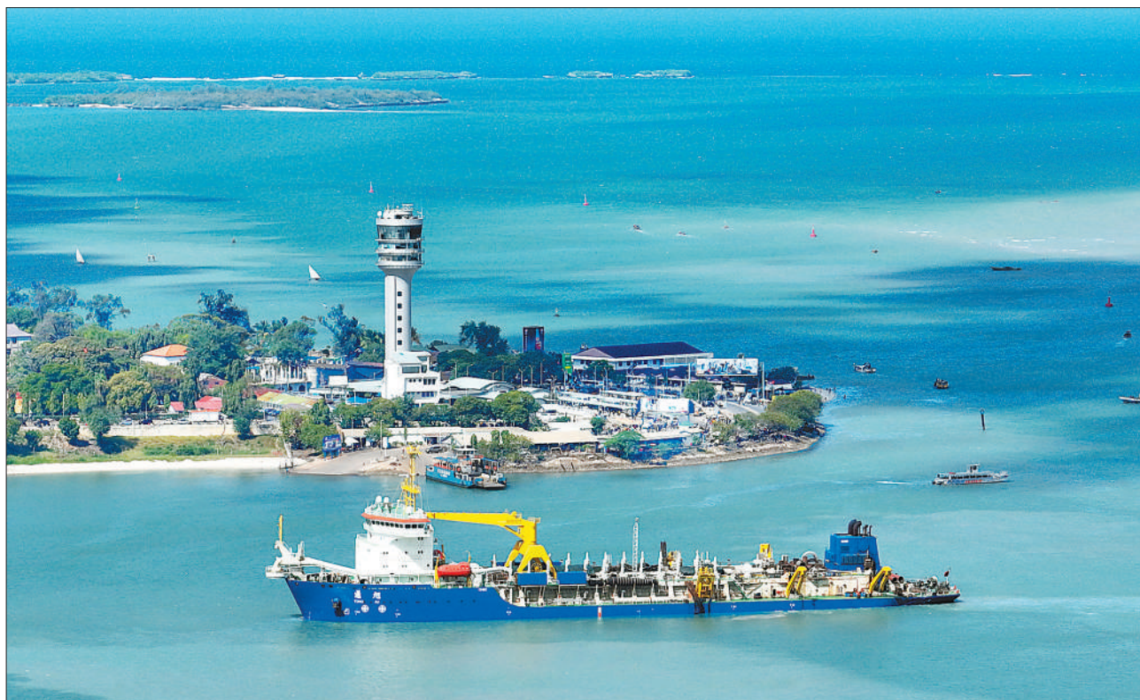
上图：中国自主设计、投资建造的重型自航耙吸式挖泥船“通旭”号正在达累斯萨拉姆港进行疏浚作业。 下 亮摄 右图：项目员工在马卡通贝岛更换航标灯。
