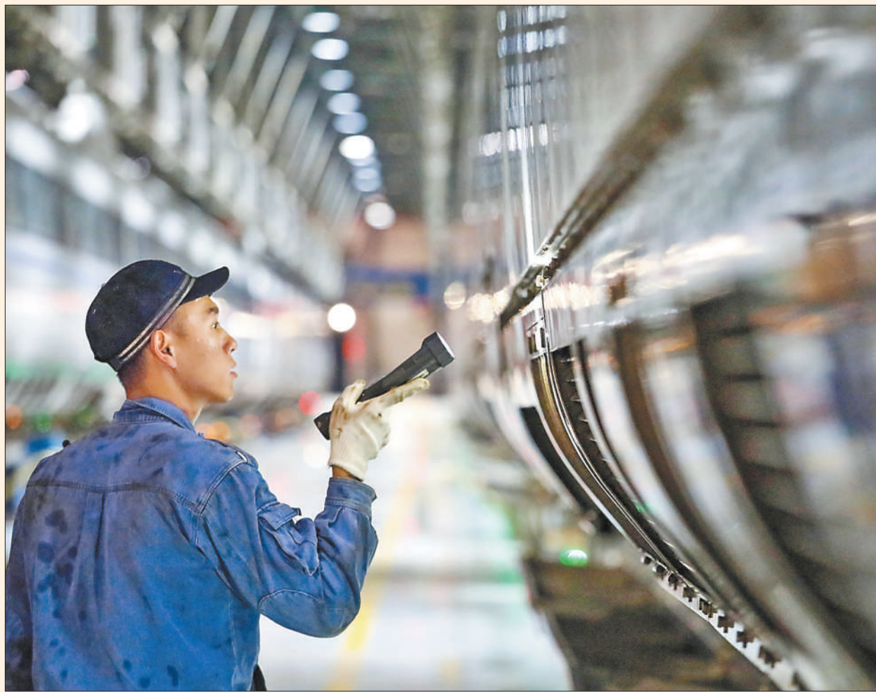
春运期间，国铁昆明局昆明车辆段动车组运用所地勤机械师细心检查车侧裙板螺栓状态，护航春运回家路。
