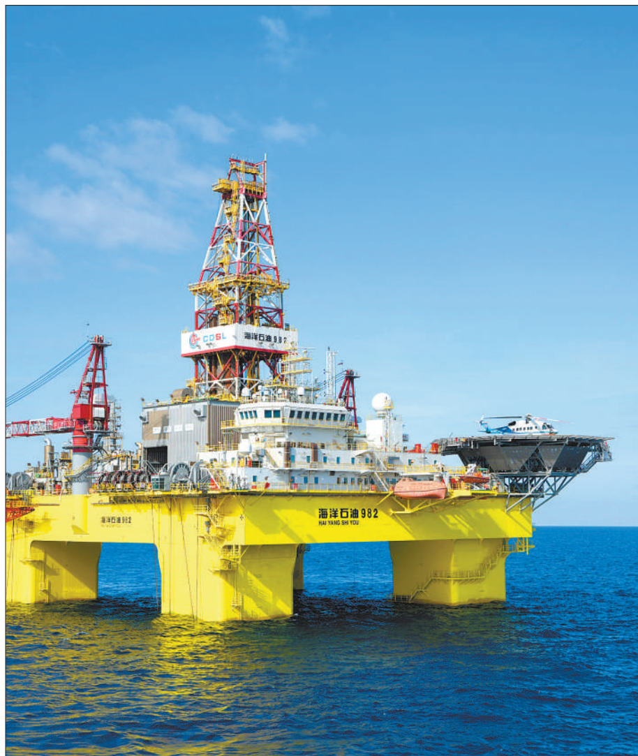
“海洋石油982”半潜式钻井平台是我国自主投资建造的第六代深水半潜式钻井平台，最大钻井深度9144米。新华社记者 王毓国摄
