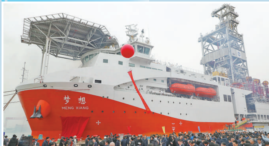
▲2023年12月,我国自主设计建造的首艘大洋钻探船被命名为“梦想”号,并在广东广州南沙区首次试航。“梦想”号约3.3万吨,续航力1.5万海里,具备1.1万米钻探能力。图为“梦想”号命名仪式现场。 新华社记者 黄国保摄
