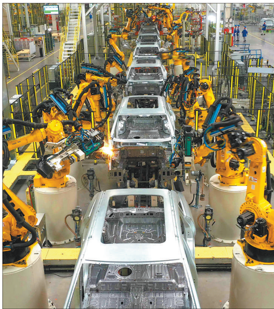
山东省青岛市即墨区一家汽车制造企业的焊装车间，机器人在进行焊接作业。
