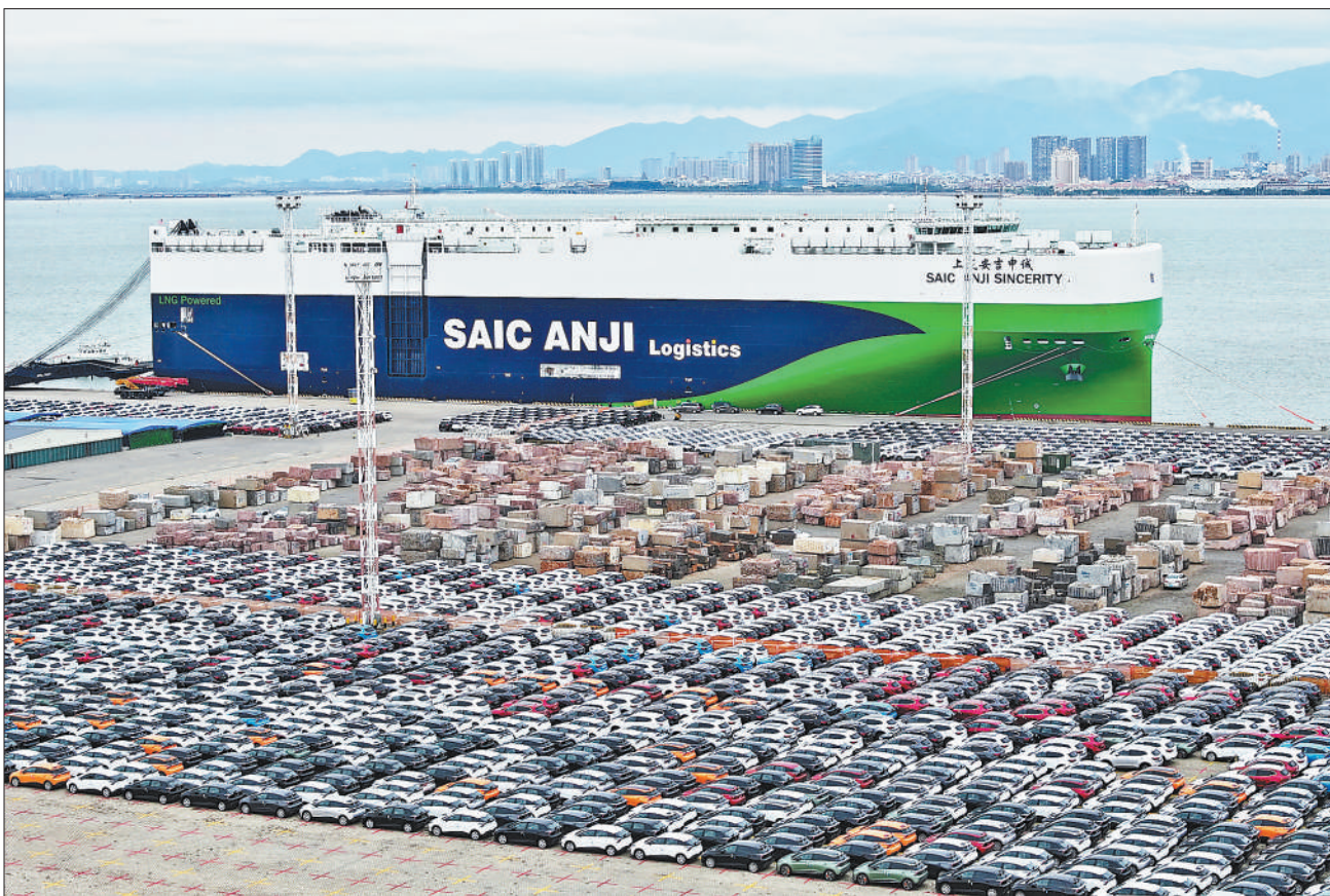
1月23日，在福建厦门东渡港区现代码头，3700余辆汽车陆续驶上“上汽安吉申诚”号汽车滚装船。船只1月24日将从厦门港起航，驶向欧洲，这是厦门口岸单航次最大批量汽车出口。“上汽安吉申诚”号汽车滚装船200米长、38米宽，相当于13层楼高，拥有7600个车位，排水量超过4万吨，采用LNG双燃料清洁动力，能够减少30%的二氧化碳排放，是全球现役载量最大、国产化程度最高的清洁能源滚装船。图为当天，“上汽安吉申诚”号汽车滚装船停靠在东渡港区现代码头(无人机照片)。
