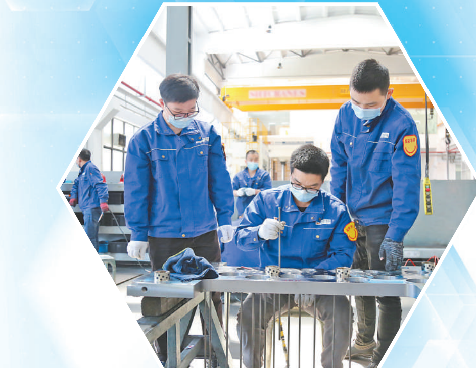
▲在宁波兴利汽车模具有限公司，技能导师带领实习生给汽车注塑模具配顶针板。 徐铭摄(人民视觉)
