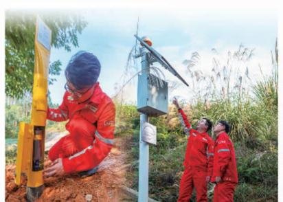
千寻位置油气管道智慧桩、地质灾害监测设备
