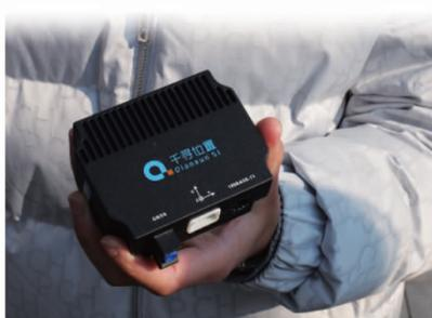
千寻位置车规级高精度组合导航定位控制器
