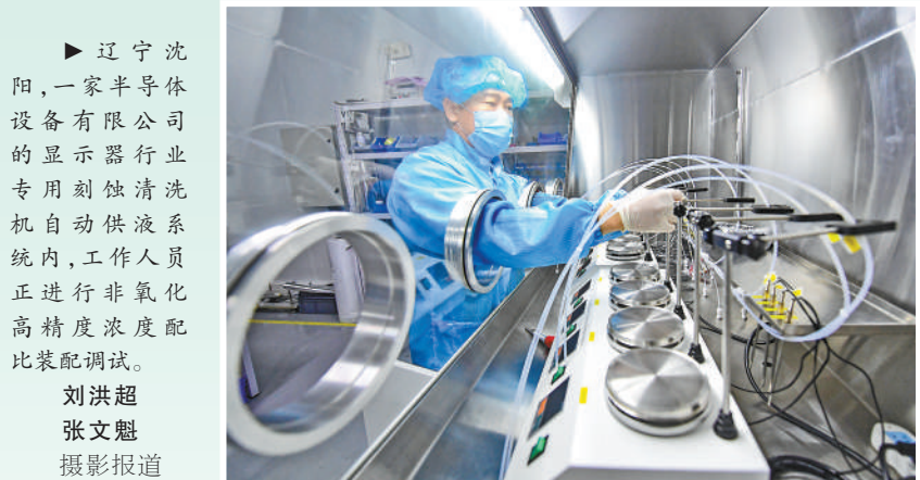
▲辽宁沈阳，一家半导体设备有限公司的显示器行业专用刻蚀清洗机自动供液系统内，工作人员正进行非氧化高精度浓度配比装束调试。 刘洪超 张文魁 摄影报道
