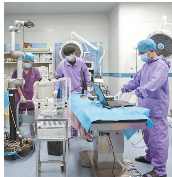
▲研究团队正在开展介入式脑机接口控制机械臂试验。南开大学供图
