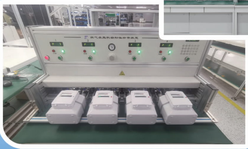
上图:工作人员正在对“星闪”智能燃气表进行计量检测
