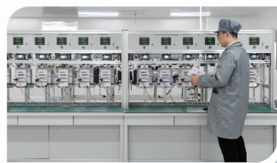
上图:工作人员正在对“星闪”智能燃气表进行计量检测
