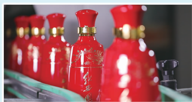
成品包装车间，全自动灌装密封一体机将原来的定量灌装、人工放盖、机器压盖三道工序“合三为一”，提高了成品质量和产量，一小时最多可灌装1.2万瓶。
