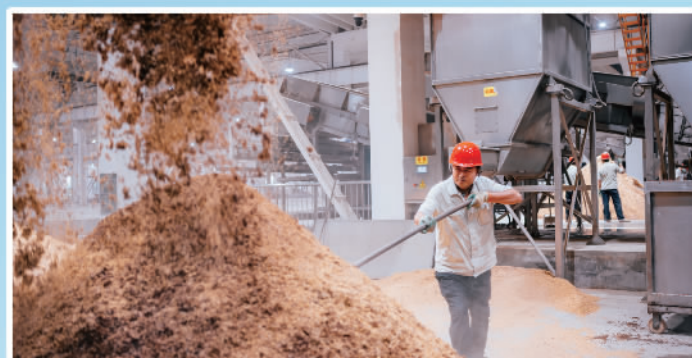
制酒环节采用土窖固态发酵，混蒸混烧续渣法工艺生产，一年一个循环周期，每年九月立窖。每年一次腾空窖池、更换窖皮泥，始终保持窖泥“熟而不老”、酒醅“香而不陈”，使新酒具有清而不淡、浓而不艳、诸味协调的独特风格。
