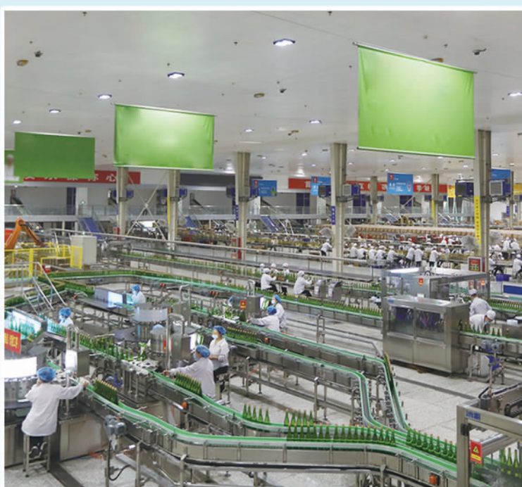
成品包装车间，全自动灌装密封一体机将原来的定量灌装、人工放盖、机器压盖三道工序“合三为一”，提高了成品质量和产量，一小时最多可灌装1.2万瓶。
