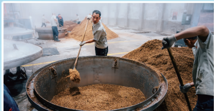
制酒环节采用土窖固态发酵，混蒸混烧续渣法工艺生产，一年一个循环周期，每年九月立窖。每年一次腾空窖池、更换窖皮泥，始终保持窖泥“熟而不老”、酒醅“香而不陈”，使新酒具有清而不淡、浓而不艳、诸味协调的独特风格。
