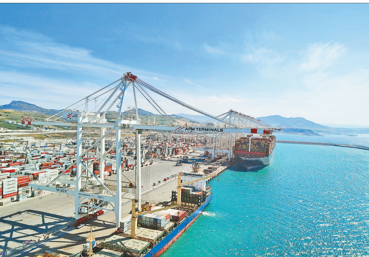
摩洛哥的丹吉尔地中海港口位于直布罗陀海峡西面入口，是北非海运航线上的主要港口。近年来，中国企业积极参与该港口和自贸区建设，提供的相关设备有力支持了港口自动化建设。图为振华重工为丹吉尔码头定制的超3E级超大型岸桥。张富宽摄
