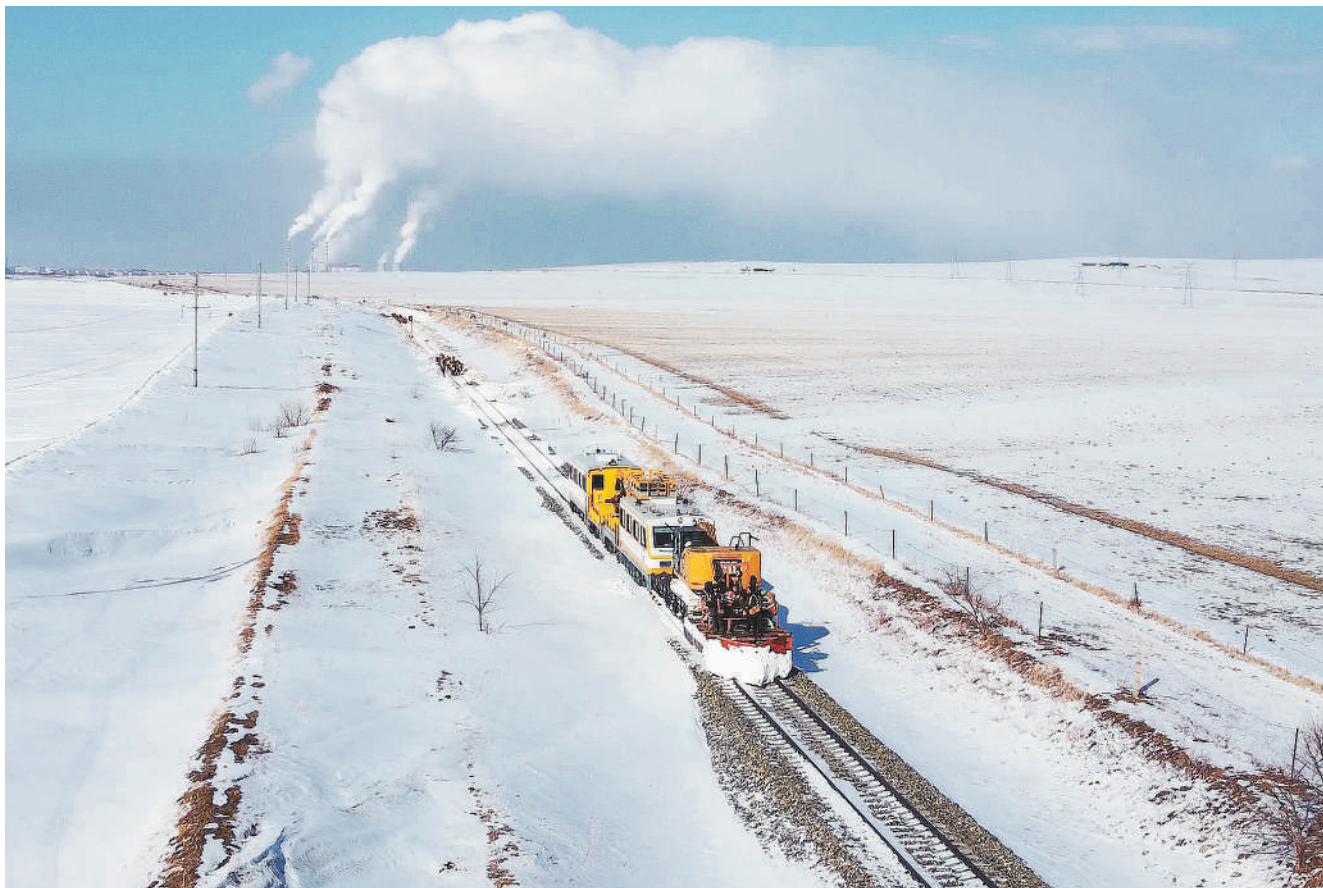
受强冷空气影响，东北地区近日出现降雪、雨夹雪天气，部分地区冻雨与降雪叠加，给交通带来一定影响。中国铁路哈尔滨局集团有限公司对受降雪影响主要铁路区段启动预警，组织5000余名铁路职工，调集大功率风力除雪机、除雪车辆等设备，对站场道岔、股道及线路、桥梁、隧道端口处的积雪进行清除，减少对运输秩序的影响。图为11月6日，轨道除雪车对积雪区段线路进行持续检查巡视和除雪。
