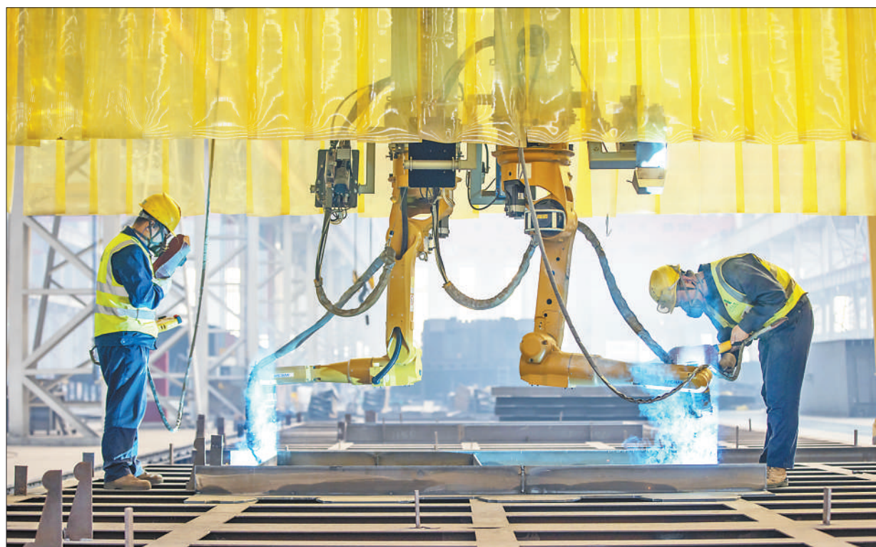
日前,位于山东济南钢城经济开发区的一家企业生产车间内,工人们正通过自动化焊接机器人对桥梁板进行自动焊接。
