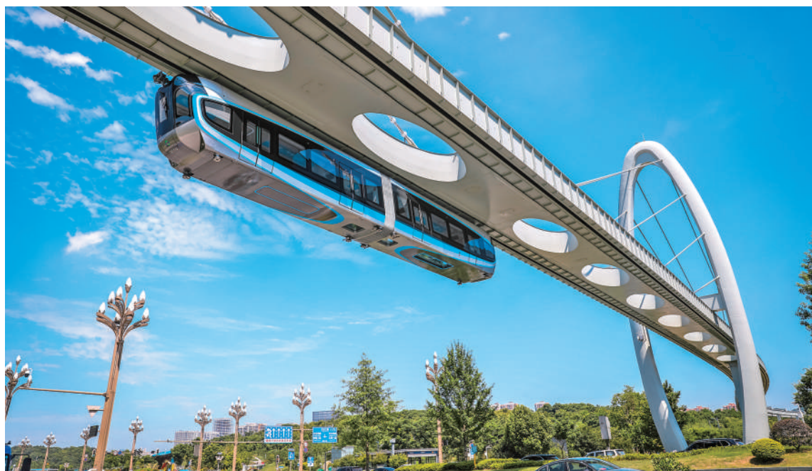
我国首条悬挂式空中轨道列车“光谷光子号”空轨9月26日在湖北武汉东湖高新区开通运营。列车采用全自动无人驾驶模式运营,最高运行时速达60公里。范昊天 黄策 摄影报道(人民视觉)
