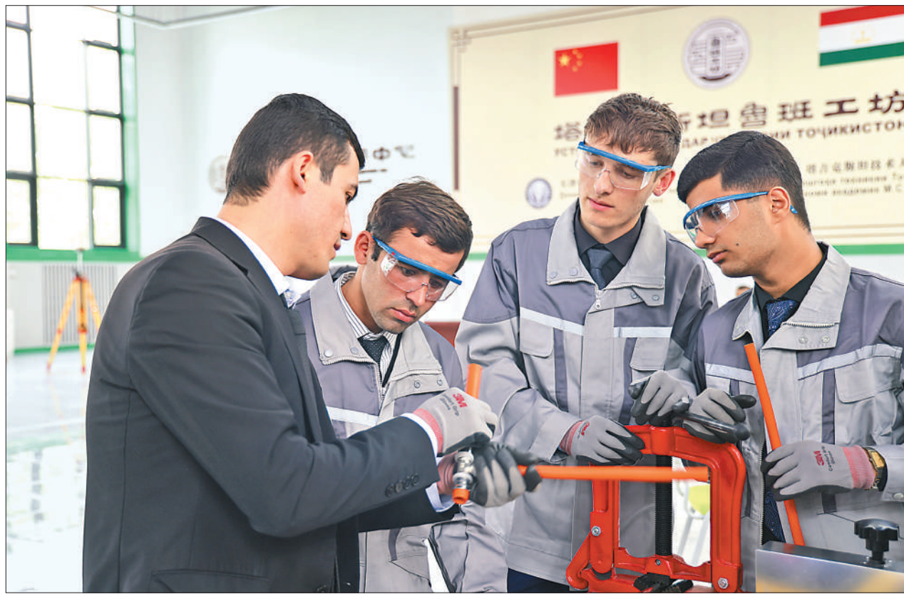
在塔吉克斯坦鲁班工坊内，塔方老师正在向学生讲解如何对铝塑管进行卡压连接。 本报记者 颜欢 摄
