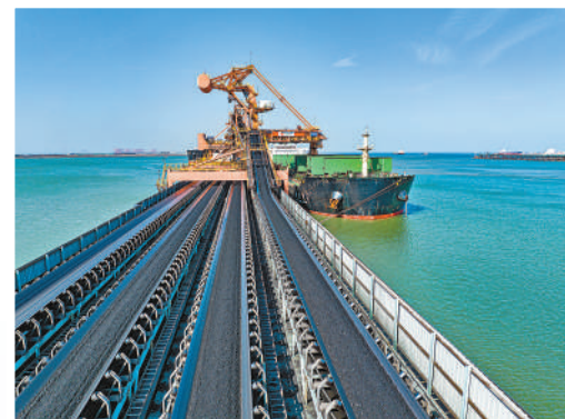
在黄骅港,皮带机将煤炭传送到货船上。刘建玲摄(人民视觉)
