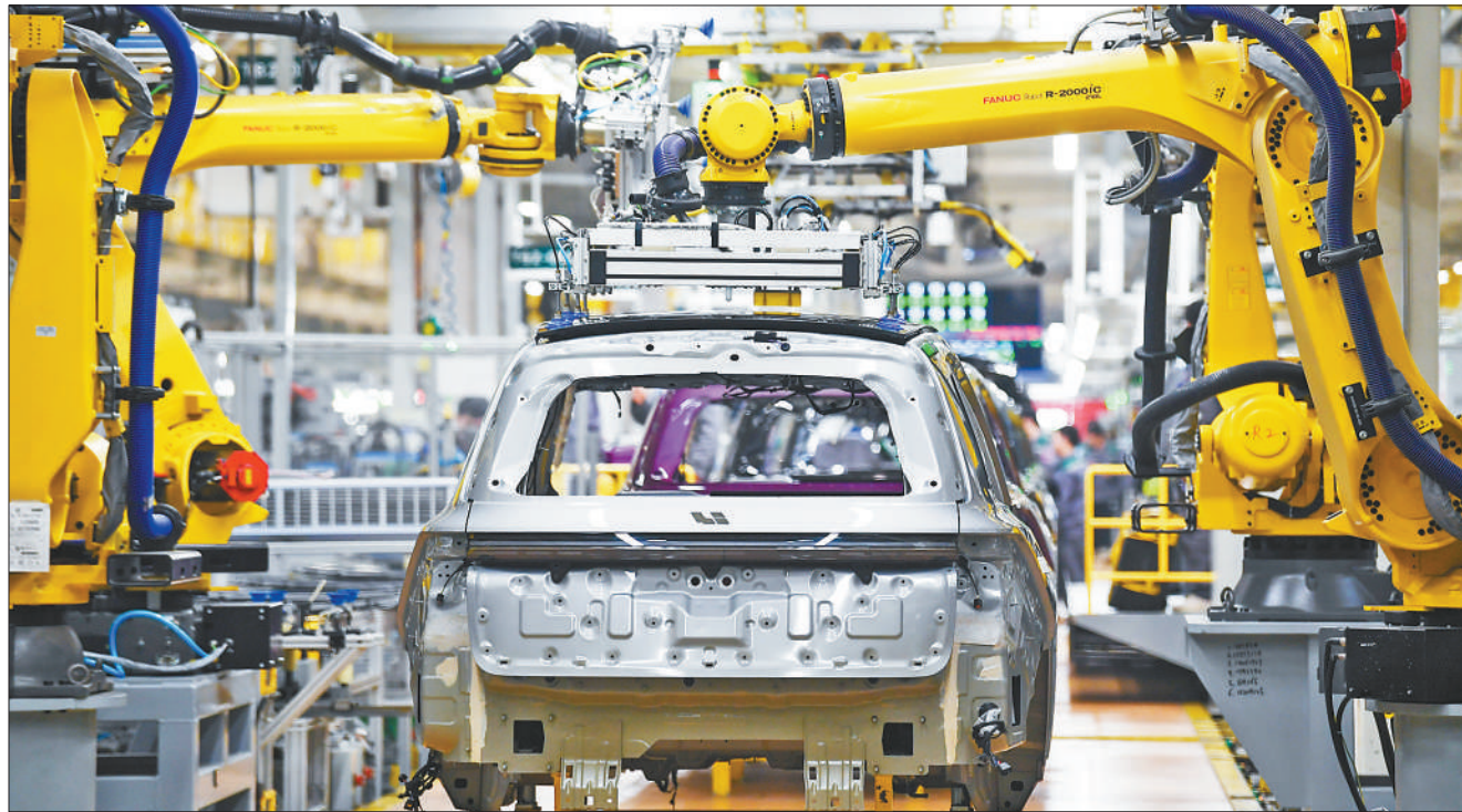
新能源汽车生产线上，机器人在安装车窗玻璃。 新华社记者 李博摄
