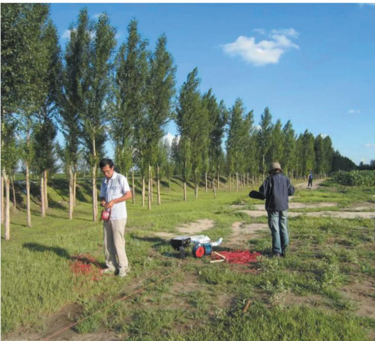
中科院沈阳应用生态研究所防护林研究团队宋立宁研究员(左)和卢德亮博士(右)在科尔沁沙地农田防护林带利用大地阻抗仪测定地下水位。
