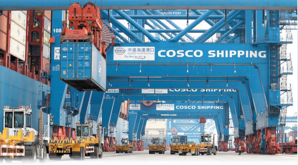
中远海运港口阿联酋阿布扎比码头采用岸桥预留自动化和堆场自动化作业模式，可作业超2万标准箱大型船舶，年设计能力250万标准箱。 本报中东中心分社 纳达尔·达乌德摄
