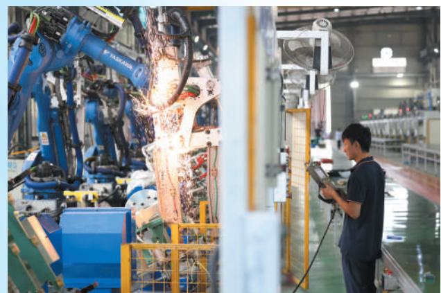
配件生产环节 福建福州一家汽车配件企业,智能机械手臂在生产汽车配件。 王旺旺摄(影像中国)
