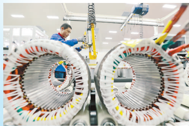
电机生产环节 浙江湖州一家电机公司,工人在赶制新能源汽车驱动电机。 谢尚国摄(影像中国)
