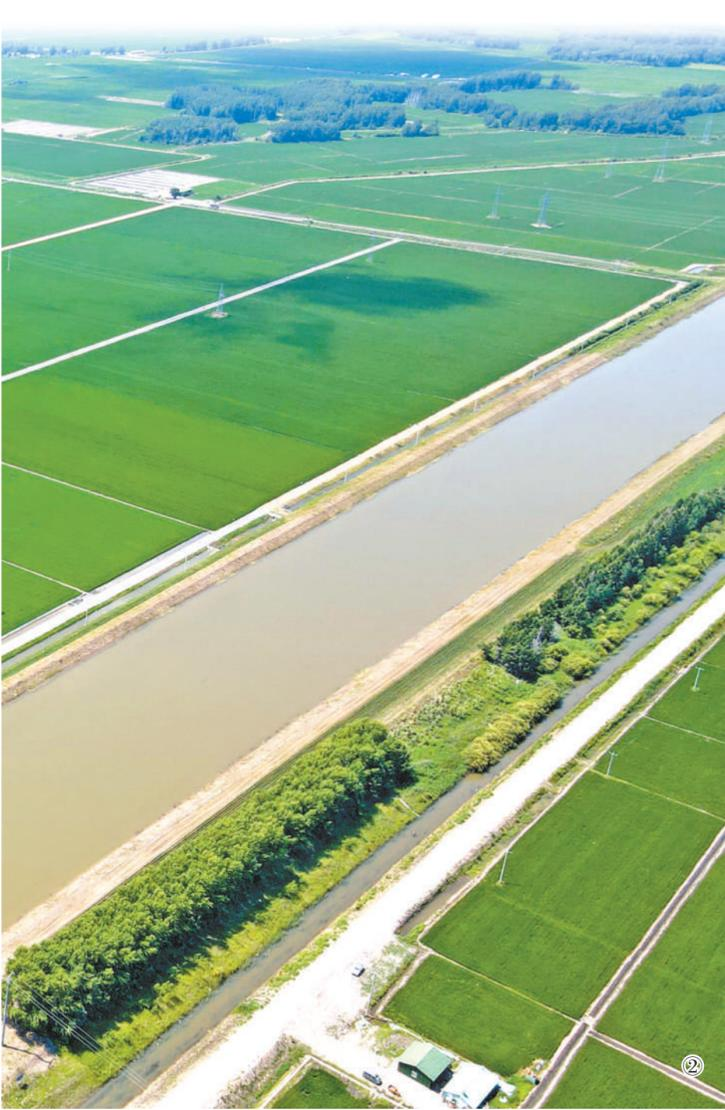
方方正正的格田，一路贯中、两侧为田、四周布渠，土地平整，不再积水。据测算，改造后田埂减少，有效种植面积又增加4%以上，省下一成多的灌溉用水。据统计，北大荒集团建三江分公司积极推广水田标准化改造工程建设，已完成60万亩格田改造。
