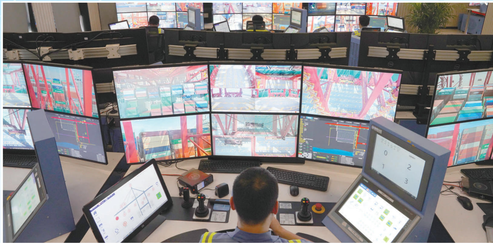
桥吊司机通过智能操控平台远程作业。 本报记者 李 舸摄
