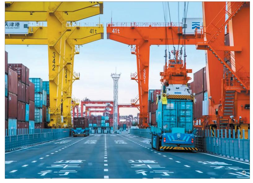
看,它只是一个巨大的卡车底盘。近看,车身上有许多"门道"——车辆四角有圆柱凸起,这是用于避障的激光雷达和摄像头;车架经过减重和强化,极限载重量提升至80吨;载货平面彰显人性化设计,位置与工人解锁作业的高度一致;车辆侧面还配有自动充电口,充电1小时即可满电运行……
