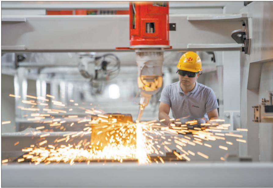
华工科技产业股份有限公司工程师在三维五轴激光切割机前做工艺测试。
