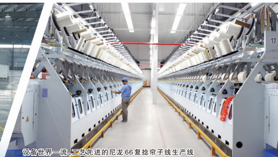
设备世界一流、工艺先进的尼龙66复捻帘子线生产线
