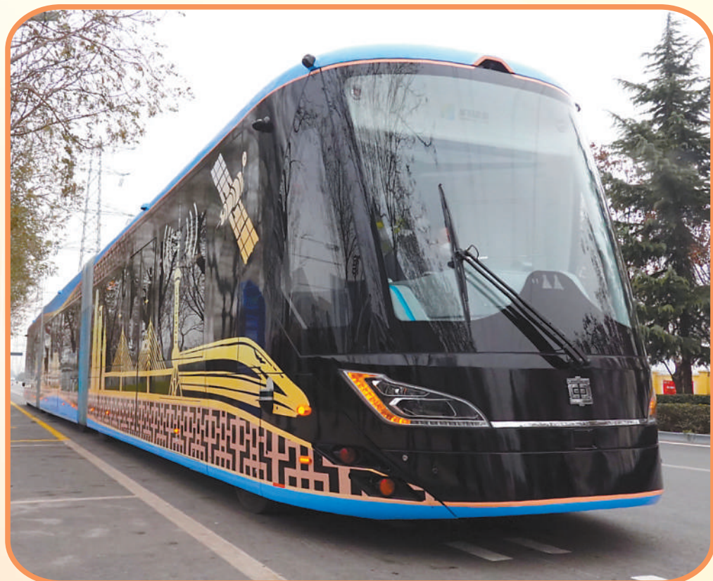
陕西省咸阳高新区，最大载客可达300人的“智轨列车”载客试跑。该列车运用智轨快运系统，以车载传感器识别路面虚拟轨道，能实现在既定虚拟轨道行驶。 张远摄(影像中国)
