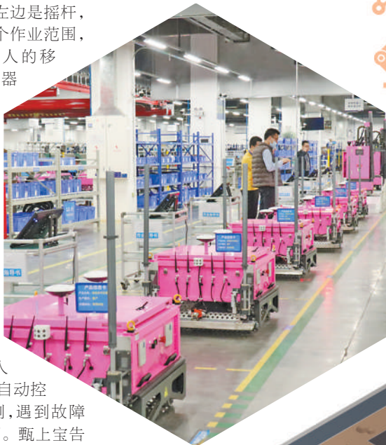
▲图为组装好的地面抹平机器人。 蔡晓格摄 (影像中国)
