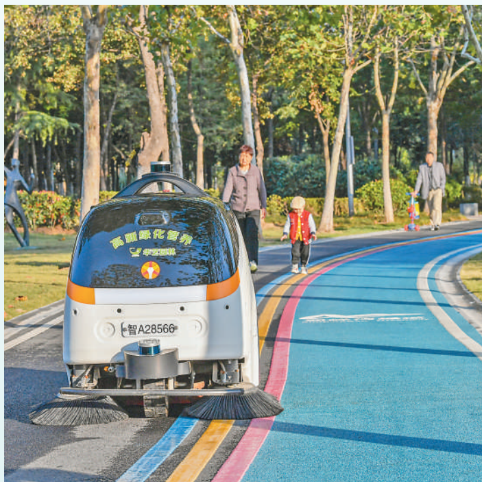
左图:安徽省合肥市高新区蜀峰湾体育公园,智能化无人驾驶清扫车在作业中。智能化无人驾驶清扫车,作业时按设定路线行驶,通过摄像头和传感器避障,并分辨需要清扫的垃圾,减轻了环卫工人劳动强度,提升了清扫保洁效率。
