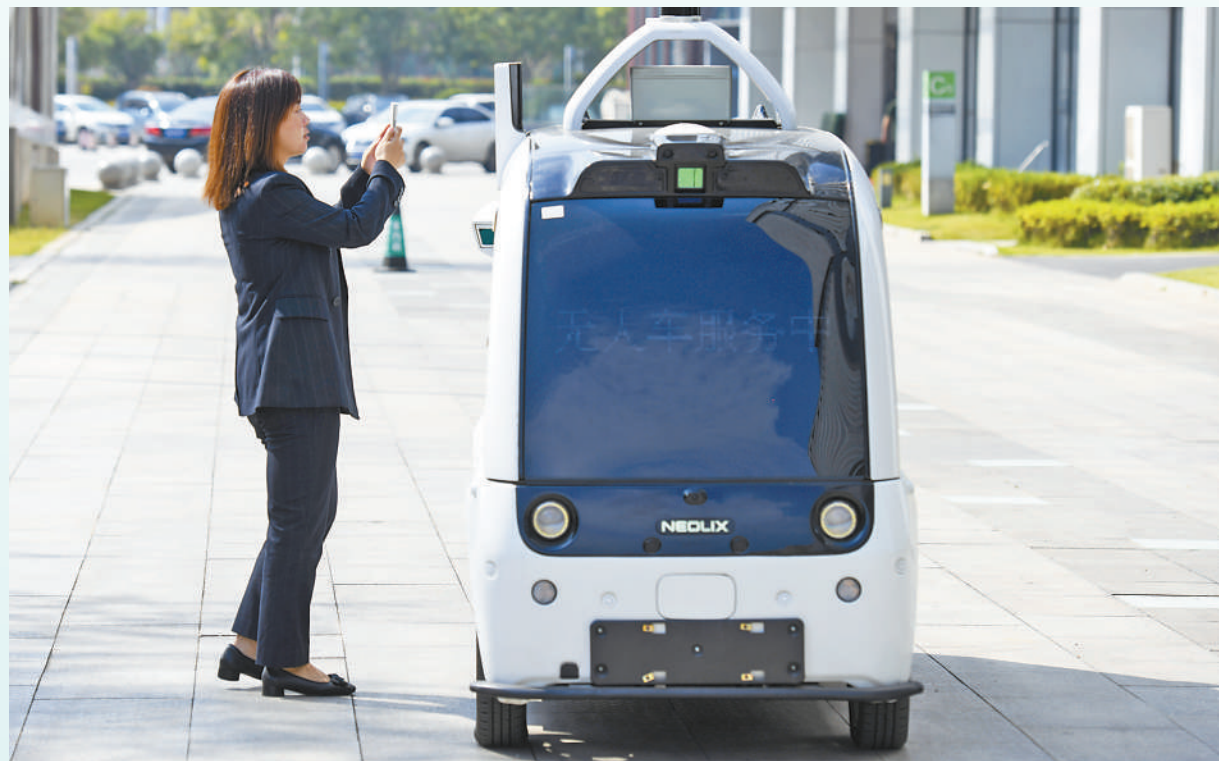
右图:湖南省长沙市一产业园内,员工对着无人驾驶零售车扫码挑选商品。无人驾驶零售车按照规划的线路行驶,其货柜可容纳饮品、食物等,并具备冷藏、加热功能,为附近员工提供便利的“无接触”购物方式。
