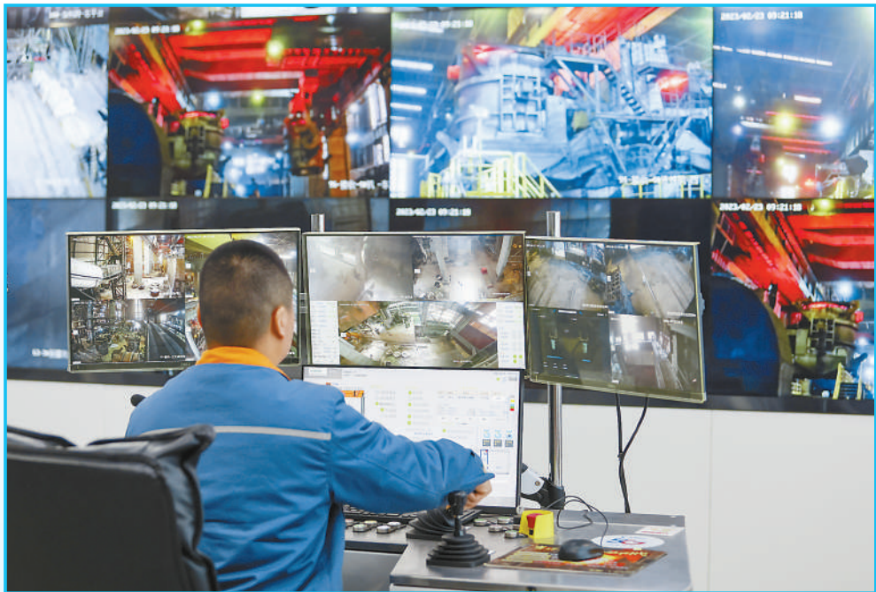
安全管控 江苏省南京市雨花台区,宝钢股份梅山钢铁行车操控中心内,工作人员在地面集控室进行远程操作。随着5G技术广泛应用,钢铁行业加快数字化转型升级,打造“5G+数字炼钢”应用场景,实现作业少人化、无人化,有效提升安全性。 冯 苒摄(人民视觉)
