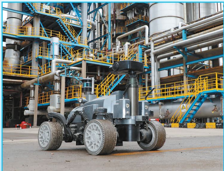
设备管理 山东省东营市,东营区化工产业园区内,智能巡检机器人在巡检厂区设备,实时采集现场图像、声音、温度等数据,对设备实现精准管理,保障厂区正常运转。 刘智峰摄(影像中国)
