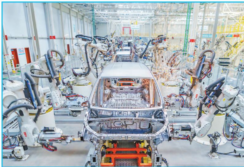
生产作业 山西省运城市,大运新能源汽车的冲焊车间内,智能焊接机械臂在进行车架焊接作业。近年来,运城市大力发展汽车产业,打造绿色环保、智能化的智慧生产线,让数字技术助推产业升级。 闫 鑫摄(影像中国)
