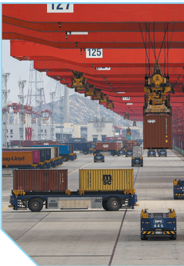
无人驾驶的全自动导引车(AGV)在港区内穿梭往来，搬运集装箱。 方敏 王初摄影报道
