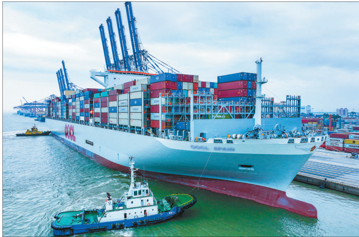
3月24日,国产全球最大载箱量集装箱船靠泊广州南沙二期集装箱码头。该轮于3月15日交付,船长399.99米,型宽61.3米,型深33.2米,载重量达22.8万吨,甲板面积相当于3.5个标准足球场,可装载24188个标准集装箱。
