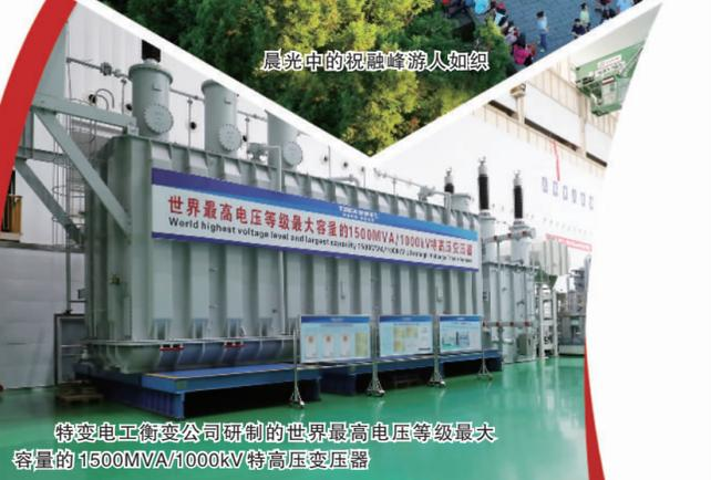
特变电工衡变公司研制的世界最高电压等级最大容量的1500MVA/1000kV特高压变压器
