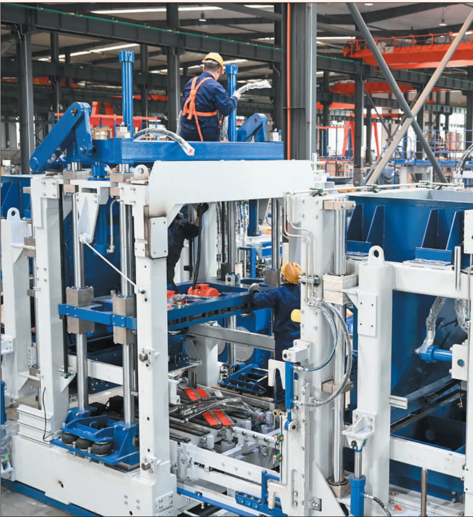
图为近日，福建泉工股份有限公司工作人员在安装销往海外的全自动砌块成型机。 新华社记者 林善传摄(影像中国)
