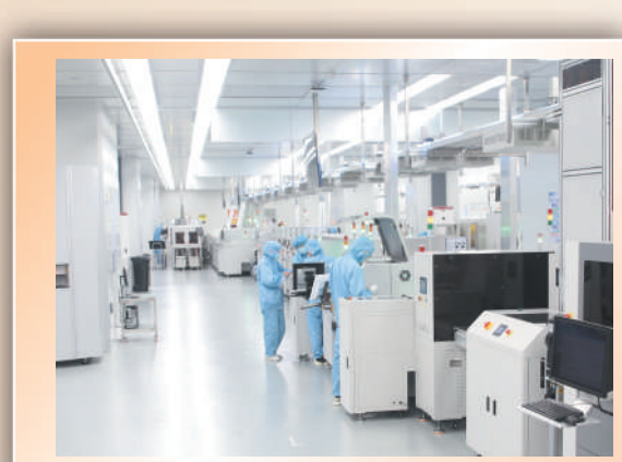
▶记者在小米亦庄智能工厂调研主板表面元器件贴装工序时，工程师们正在调试锡膏印刷参数。
