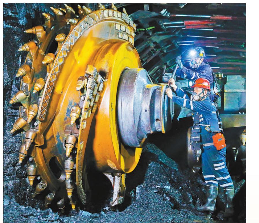
1月10日,内蒙古自治区鄂尔多斯市,山东能源西北矿业贵陶勒盖煤炭公司巴彦高勒煤矿的职工在检修采煤机,确保春节期间生产运行。李战鹏摄(人民视觉)
