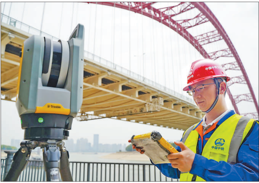
吕宏奎正在使用三维扫描仪对晴川桥进行全面扫描。 金雨蒙摄(人民视觉)
