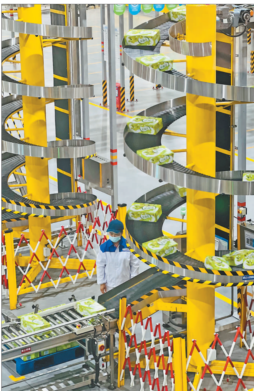
陕西咸阳市清河食品工业园区，一家乳业公司的生产车间内，自动化生产线正在对乳制品进行打包作业。
