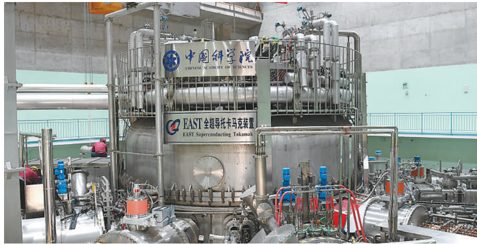
工作人员对全超导托卡马克核聚变实验装置(EAST)进行升级改造。
