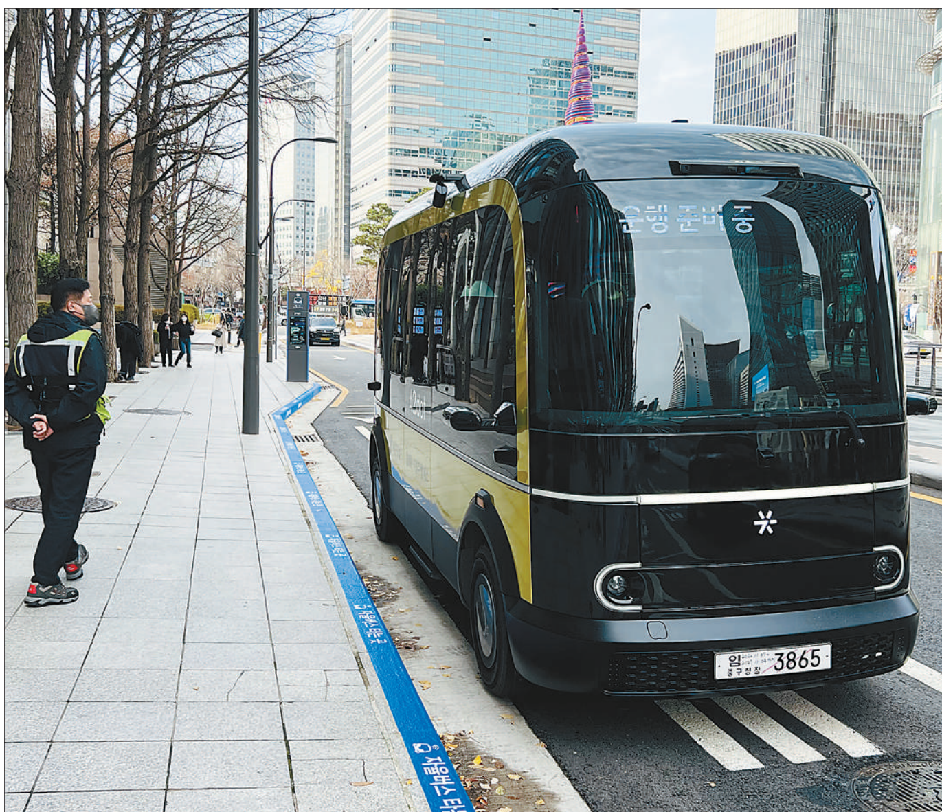
近期,一条双向里程约3.4公里的自动驾驶巴士线路在韩国首尔清溪川地区开通。首尔市民下载相关手机应用程序即可免费乘坐自动驾驶巴士。据首尔市政府介绍,运行在该线路上的自动驾驶巴士能够快速识别红绿灯、行人和障碍物等周围环境,执行避障、紧急制动等任务。图为自动驾驶巴士停靠在站点。
