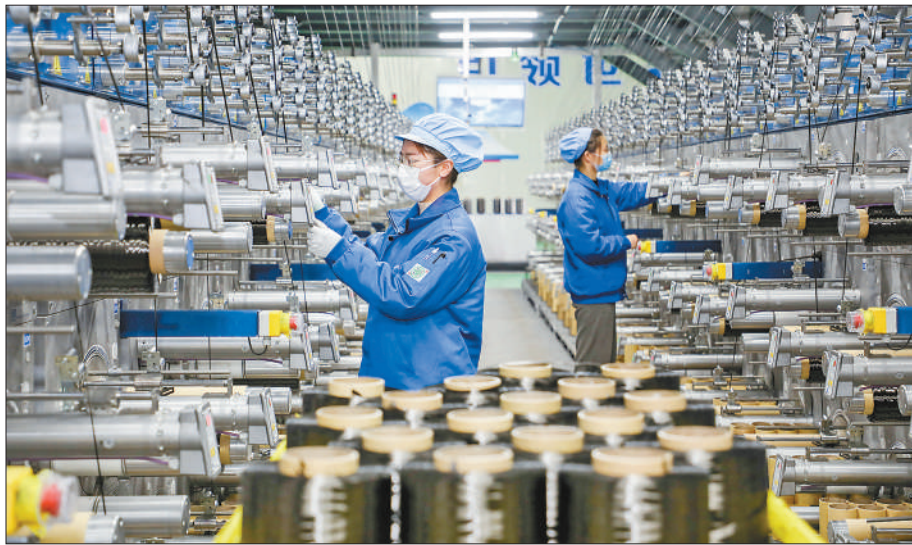
上图:在山东省威海市临港区高性能碳纤维产业园生产车间,工人正在对生产的碳纤维原丝进行收集。 孙大伟摄(影像中国)
