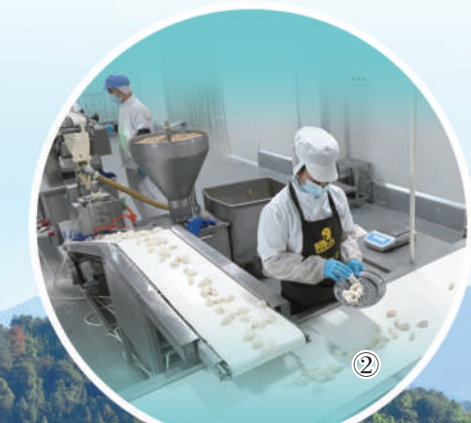
图②：沙县小吃中央厨房的蒸饺自动化生产线。
