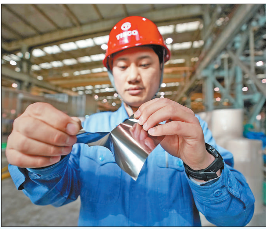
在中国宝武太钢不锈钢精密带钢有限公司,一名工作人员展示“手撕钢”。作为一种高端材料,“手撕钢”在航空航天、高端电子、通信等行业都发挥着重要作用。目前该公司生产的“手撕钢”厚度仅0.015毫米,为全球最薄。 新华社记者 詹 彦 摄
