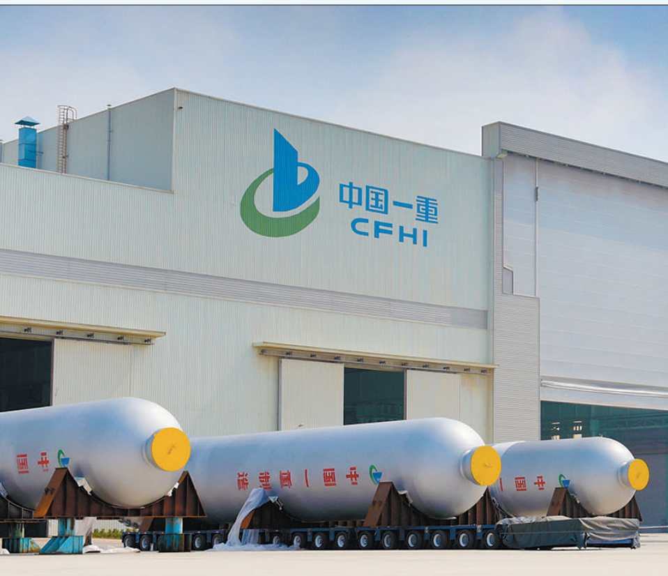
在中国一重大连石化装备制造基地,企业承制的千吨级锻焊加氢反应器整齐排列。中国一重生产的加氢反应器多次刷新世界纪录,超大吨位石化装备制造技术保持国际领先。 马春华摄(人民视觉)
