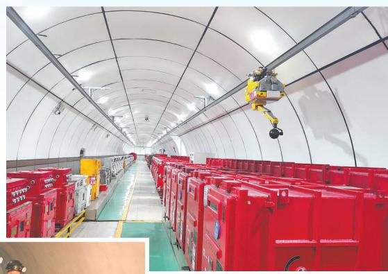
图②: 陕煤集团井下设备巡检机器人, 搭载各种传 度数据、烟雾、多种气体浓度参数等信息,便于发现故障 问题,减轻人员巡检劳动强度,提高准确度。
