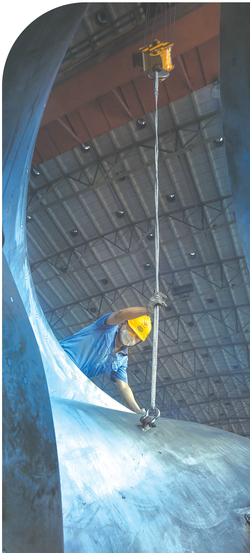
图①：工人正在对白鹤滩水电站百万千瓦水电机组转轮叶片进行装配作业。白鹤滩机组精品标准要求磁轭中心偏差为0.15毫米，叠装形成的磁轭中心相对理论中心偏差不得超过0.02毫米，远优于精品标准要求。东方电气集团供图
