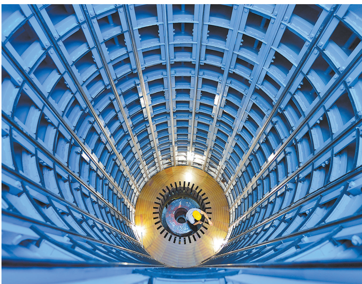
图①：工人正在对白鹤滩水电站百万千瓦水电机组转轮叶片进行装配作业。白鹤滩机组精品标准要求磁轭中心偏差为0.15毫米，叠装形成的磁轭中心相对理论中心偏差不得超过0.02毫米，远优于精品标准要求。东方电气集团供图
