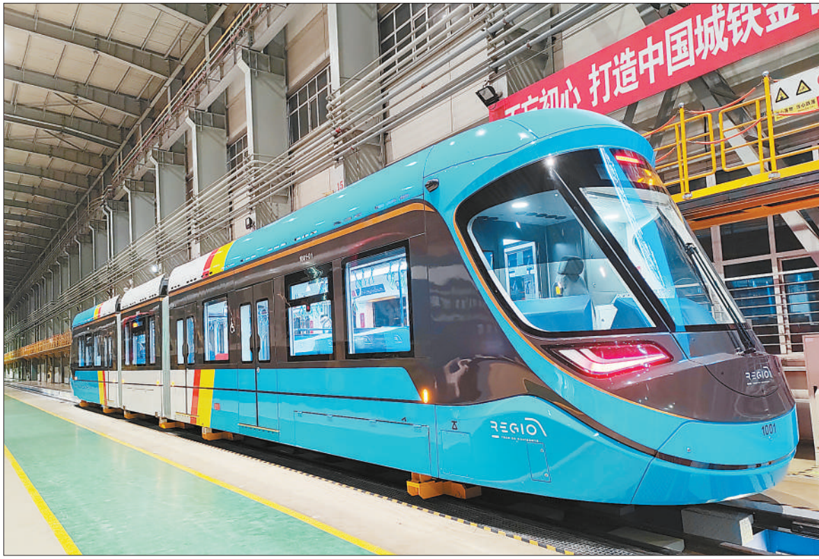
9月6日，由中车长春轨道客车股份有限公司研制的哥伦比亚西部有轨电车项目模型车在长春下线。下线仪式通过视频方式在哥伦比亚和长春两地同时进行。据介绍，项目列车为6辆编组低地板有轨电车，运营时两列车重联行驶，在车体长度、承载能力、牵引制动力性能、智能化水平、乘坐舒适度等方面均达到国际领先水平，并且针对当地高海拔、大坡道、长站间距等市场轨道交通环境量身定制。
