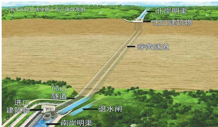
图为南水北调中线穿黄工程三维效果图。
