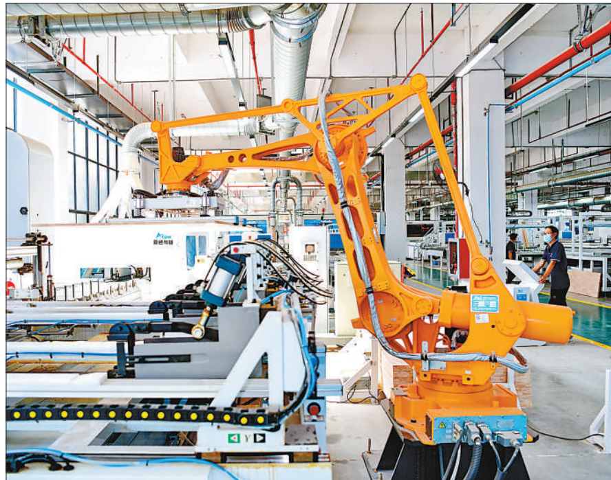
近日,江西省赣州市南康区家具零部件共享配料制作中心,工人在数字化生产线导入编程代码,遥控操作机械臂、传送带和数控切割机智能设备加工零件。
