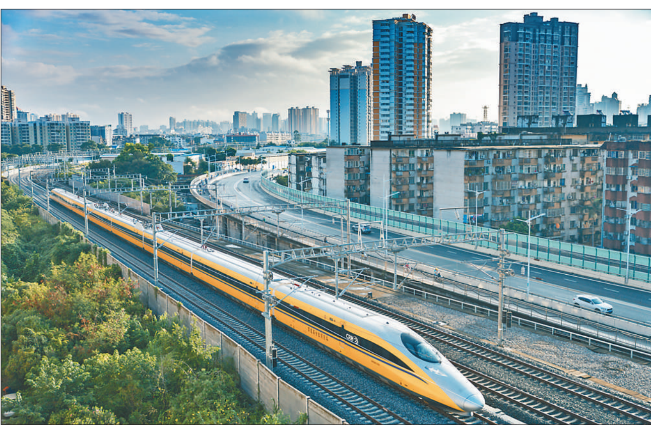
8月22日,一列高速综合检测列车驶出南宁站,开往崇左南站,对广西南崇铁路进行实时检查检测,为其年内开通运营奠定基础。该列车配置通信设备、传感器、摄像头等装置,能够在运行途中对沿线轨道、路基、通信信号、接触网等进行动态检查。图为行进作业中的高速综合检测列车。
